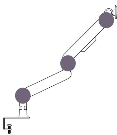
Limitador de rotación en cada articulación, limitando la rotación según 3 posiciones.
